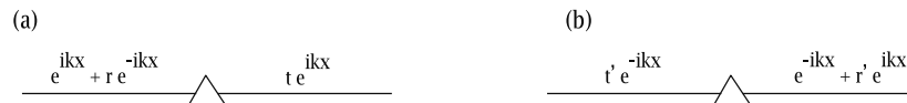
Obr. 4.10: Rozptyľ na optickom hranole 3 z predošlého obrázku v prípade, že prívod 3 je od hranola odpojený a vo vodiči nie je okrem hranola už žiadna iná prekážka. Symbol t ( t ) je amplitúda pravdepodobnosti prechodu pre vlnu dopadajúcu zprava (zľava), symbol r ( r ) je amplitúda pravdepodobnosti odrazu pre vlnu dopadajúcu zprava (zľava).
